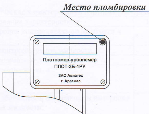
Рисунок 2 – Схема пломбировки плотномеров-уровнемеров ПЛОТ-3Б-1РУ
